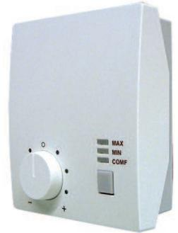
Ist die Stufe COMF (Comfort) eingestellt, kann mit dem Handrad der Luftvolumenstrom noch individuell (stufenlos) gegenüber dem ausgelegtem Volumenstrom um 35 % gesenkt oder erhöht werden. Bei den Stufen MIN und MAX kann kein Einfluss genommen werden.
